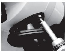
Проденьте винты в фиксатор прижимной пластины, закрепленной на станке
